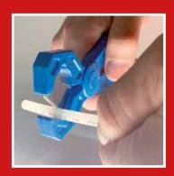
Mediante la taglia tubi in dotazione, tagliare a 90° la parte del tubo assicurandosi che il taglio sia pulito, senza sbavature o schiacciamenti.
